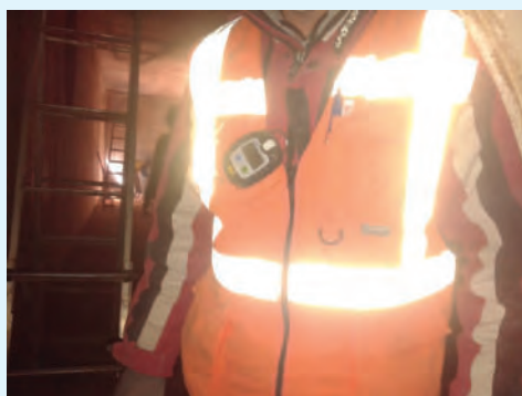
Medidor de gases en el interior y al acceso en trabajos en espacios confinados
