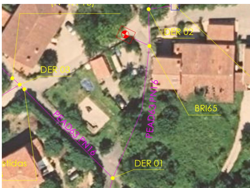
Derivaciones principales en la línea de distribución
