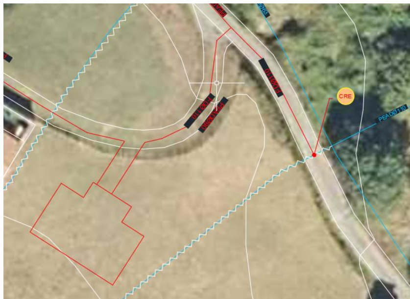
CRE. Conexión con línea de llenado desde depósito de Baltzola
